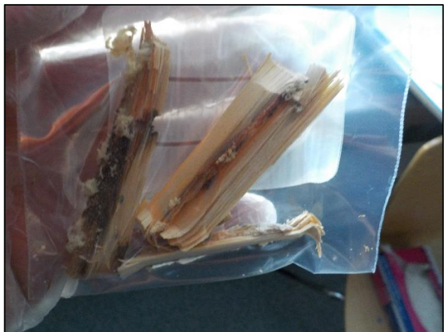
Kuva 4.8. Vasemmalla yleiskuvaa apukarmista rakenneavauksesta AUS-5, jossa apukarmi on tummunut. Oikealla kuva näytteestä A 22 (rakenneavaus AUS-4), jossa myös puu on tummunut kosteusra- situksen seurauksena.
